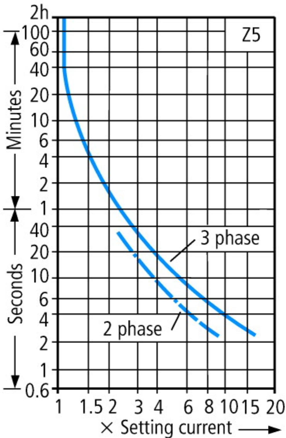
Данные характеристики расцепления являются средними значениями полос разброса при температуре окружающей среды 20 °С из холодного состояния. Время расцепления зависит от тока срабатывания.
