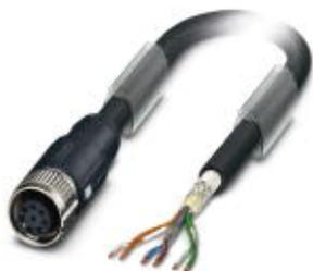
Системный кабель шины, VARAN (100 Мбит/с), 6-полюсн., SANTOPRENE без галогенов/ТРЕ без галогенов, черный RAL 9005, экранирован., свободный конец, к гнезду прямое M12 SPEEDCON, A-кодирование, длина кабеля: 10 м
