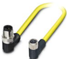
Кабель для датчика / исполнительного элемента, 3-полюсн., ПВХ, желтый, Штекеры угловой M12 SPEEDCON, A-кодирование, к Гнездо угловой M8, длина кабеля: 1,5 м
