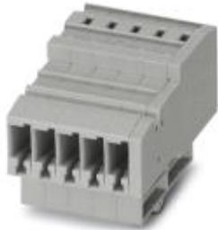
Соединитель COMBI, номинальное напряжение: 800 В, номинальный ток: 32 А, тип подключения: Пружинный зажим, количество точек подсоединения: 2, полюсов: 5, сечение: 0,08 мм<sup>2</sup> - 6 мм<sup>2</sup>, AWG: 28 - 10, ширина: 31 мм, высота: 31 мм, цвет: серый, тип монтажа: на монтажную пластину
