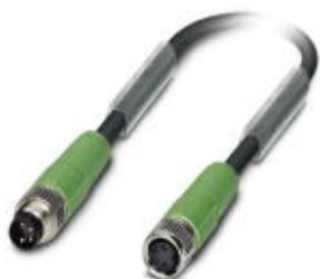
Кабель для датчика / исполнительного элемента, 4-полюсн., PUR без галогенов, темно-серый RAL 7021, экранирован., Штекеры прямое M8, к Гнездо прямое M8, длина кабеля: 0,6 м
