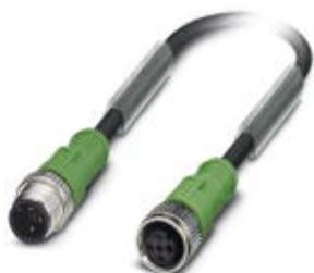
Кабель для датчика / исполнительного элемента, 3-полюсн., PUR без галогенов, темно-серый RAL 7021, Штекеры прямое M12, А-кодирование, к Гнездо прямое M12, А-кодирование, длина кабеля: 0,6 м
