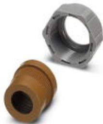
Резьбовой сальник Pg21 с частично нарезанной резьбой, пластмассовый, в комплекте с резиновым уплотнением с овальными отверстиями и прижимной винтовой деталью, для корпусов исполнения 2 - 4, диаметр кабеля: 20 x 7 мм
