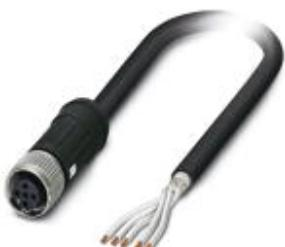
Кабель для датчика / исполнительного элемента, 5-полюсн., PE-X без галогенов, черный, экранирован., свободный конец, к Гнездо прямое M12 SPEEDCON, А-кодирование, длина кабеля: 2 м, для железнодорожного транспорта
