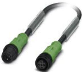
Кабель для датчика / исполнительного элемента, 3-полюсн., PUR без галогенов, темно-серый RAL 7021, Штекеры прямое M12, А-кодирование, к Гнездо прямое M12, А-кодирование, длина кабеля: 0,6 м, с пластмассовой накатанной гайкой
