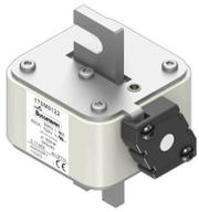
Предохранитель, высокая скорость, 900 A, AC 1000 V, size 3, 76 x 90 x 141 мм, aR, IEC, одинарный индикатор
