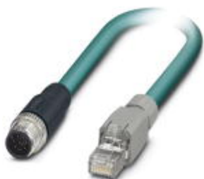
Сетевой кабель, Ethernet CAT5 (1 Гбит/с), 8-полюсн., PUR, Штекеры прямое M12, к Штекеры прямое RJ45, длина кабеля: 2 м
