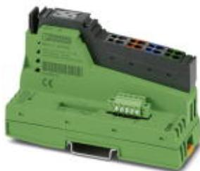
Inline XC, Устройство сопряжения с шиной, CANopen®, MINI COMBICON, Исполнение для тяжелых условий эксплуатации, скорость передачи данных в локальнойшине: 500 кбит/с / 2 Мбит/с, степень защиты: IP20, с сетевым штекером, штекером Inline и полем для маркировки
