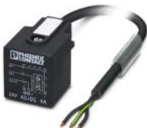
Кабель для датчика / исполнительного элемента, свободный конец, к Штекер типа А для электромагнитного клапана, с 1 светодиод, подключение с помощью Диод Зенера
