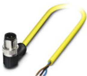
Кабель для датчика / исполнительного элемента, 3-полюсн., ПВХ, желтый, Штекеры угловой M12 SPEEDCON, A-кодирование, к свободный конец, длина кабеля: 5 м
