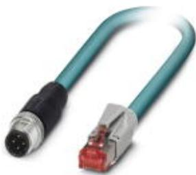
Сетевой кабель, Ethernet CAT5 (100 Мбит/с), 4-полюсн., PUR, цвет морской воды RAL 5021, экранирован., Штекеры прямое M12 / IP67, механические ключи: D, к Штекеры прямое RJ45 / IP20, длина кабеля: 3 м
