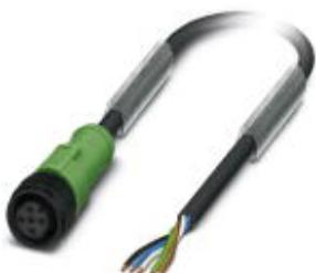
Кабель для датчика / исполнительного элемента, 5-полюсн., PUR без галогенов, темно-серый RAL 7021, свободный конец, к Гнездо прямое M12, А-кодирование, длина кабеля: 5 м, с пластмассовой накатанной гайкой
