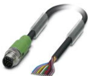
Кабель для датчика / исполнительного элемента, 12-полюсн., PUR без галогенов, черный RAL 9005, Штекеры прямое M12 SPEEDCON, А-кодирование, к свободный конец, длина кабеля: 5 м
