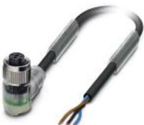
Кабель для датчика / исполнительного элемента, 3-полюсн., PUR/ПВХ, серый RAL 7001, свободный конец, к Гнездо угловой M12, А-кодирование, с 2 светодиодных, длина кабеля: 5 м
