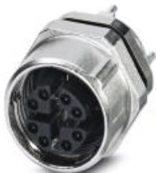
Встраиваемое гнездо CAT6<sub>A</sub>, Ethernet, 8-конт., M12-SPEEDCON, монтаж на заднюю стенку / винтовое крепление с резьбой M12, с прямыми выводами под пайку
