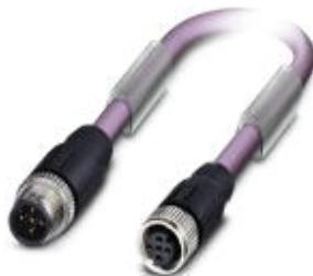
Системный кабель шины, CANopen®, DeviceNet™, 5-полюсн., PUR без галогенов, фиолетовый RAL 4001, экранирован., Штекеры прямое M12, А-кодирование, к Гнездо прямое M12, А-кодирование, длина кабеля: 7 м
