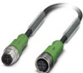
Кабель для датчика / исполнительного элемента, 5-полюсн., PUR без галогенов, темно-серый RAL 7021, экранирован., Штекеры прямое M12, А-кодирование, к Гнездо прямое M12, А-кодирование, длина кабеля: 5 м
