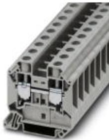
Проходные клеммы, номинальное напряжение: 1000 В, номинальный ток: 76 А, тип подключения: Винтовые зажимы, количество точек подсоединения: 2, сечение: 1,5 мм<sup>2</sup> - 25 мм<sup>2</sup>, AWG: 16 - 4, ширина: 12,2 мм, высота: 54,4 мм, цвет: серый, тип монтажа: NS 35/7,5, NS 35/15
