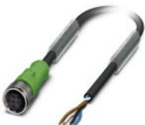
Кабель для датчика / исполнительного элемента, 4-полюсн., PUR без галогенов, темно-серый RAL 7021, свободный конец, к Гнездо прямое M12, А-кодирование, длина кабеля: 3,5 м
