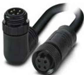
Силовой кабель, 4-полюсн., ПВХ, черный, Штекеры угловой 7/8"-16UNF, А - стандарт, к Гнездо прямое 7/8"-16UNF, А - стандарт, длина кабеля: 2 м
