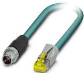
Сетевой кабель, Ethernet CAT6<sub>A</sub> (10 Гбит/с), 8-полюсн., PUR, цвет морской воды RAL 5021, Штекеры прямое M12 SPEEDCON / IP65, механические ключи: X, к Штекеры прямое RJ45 / IP20, длина кабеля: 15 м
