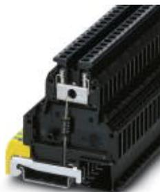
Клеммный блок с диодами-супрессорами для защиты от импульсных перенапряжений между корпусом клеммного модуля и монтажной рейкой, отдельное подключение PE, номинальное напряжение: 24 В AC, устанавливается на рейку NS 35/7,5, ширина клеммного модуля: 6,2 мм, высота клеммного модуля: 69 мм
