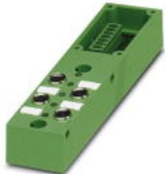
Корпус коробки датчика и исполнительного элемента, применение: Стандартн., тип подключения: Розетка M8 металл, количество гнезд: 4, полюсов: 3, механические ключи: А - стандарт, гнездо для платы: один ряд, индикатор состояния: есть, р-п-р; подключение магистрального кабеля: вставные винтовые клеммы, экранировка: нет
