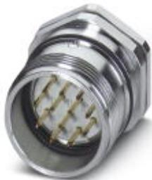
Приборные соединители с резьбой для ввинчивания M20 x 1,5, прямой, экранирован.: есть, Винтовой зажим, M23, Полясов: 8+1, тип контактов: Штифт, Подключение пайкой, Осевое уплотнение, Центральное крепление
