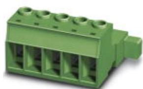
Разъемы для печатной платы, номинальный ток: 76 A, расчетное напряжение (III/2): 1000 В, полюсов: 8, размер шага: 10,16 мм, тип подключения: Винтовой зажим с натяжной гильзой, цвет: зеленый, поверхность контакта: Серебро
