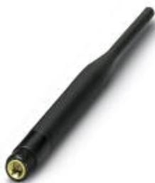
Всенаправленная антенна, 2,4 ГГц, коэфф. усиления: 5 дБи, поляризация: линейная, угол раскрытия гор./верт. 360°/45°, степень защиты: IP55, подключение: SMA (штыревой)
