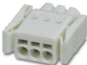
Разъемы для печатной платы, номинальный ток: 6 A, расчетное напряжение (III/2): 160 В, полюсов: 6, размер шага: 2,5 мм, тип подключения: Пружинные зажимы Push-in, цвет: белый, поверхность контакта: олово
