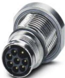
Аппаратн. соединитель, задняя стенка, прямой, для стандартной блокировки и SPEEDCON, M17, полюсов: 6+PE, тип контактов: Штифт, Обжим, Аксиальное уплотнительное кольцо, Центральное крепление, экранирован.: есть
