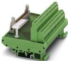
Модуль VARIOFACE с винтовыми зажимами и штыревым разъемом для плоского кабеля с короткими или удлиненными защелками, устанавливается на монтажную рейку NS 35/7,5 или NS 32, количество контактов 34
