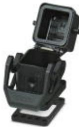
Встраиваемые корпуса D7, с одной защелкой, материал: РА, материал, защитная крышка: РА, высота: 25,5 мм, кабельный ввод: без, патрубок: Нет, защитная крышка: да, Стандартн., для вилочных вставок
