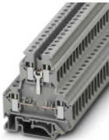
Клеммный блок, номинальное напряжение: 500 В, номинальный ток: 32 А, тип подключения: Винтовые зажимы, сечение: 0,2 мм<sup>2</sup> - 4 мм<sup>2</sup>, AWG: 24 - 12, длина: 56 мм, ширина: 6,2 мм, цвет: серый, монтаж: NS 35/7,5, NS 35/15, NS 32, номинальное напряжение: 500 В
