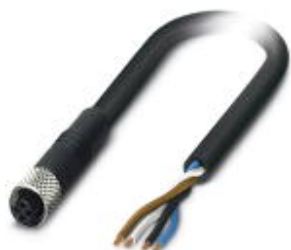
Кабель для датчика / исполнительного элемента, 4-полюсн., PUR, черный RAL 9005, свободный конец, к Гнездо прямое M5, A-кодирование, длина кабеля: 5 м
