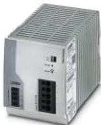
Источник питания TRIO для установки на несущую рейку с регулированием в первичной цепи, вход: 3-фазный, выход: 24 В пост. тока / 40 А, динамический разгон, быстрый монтаж жестких и гибких проводников с наконечником без инструмента
