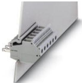
Проходная клемма, тип подключения: Винтовые зажимы, Контакты под пайку / разъем для подключения плоского штекера, полюсов: 1, ток нагрузки: 18 А, сечение: 0,2 мм<sup>2</sup> - 6 мм<sup>2</sup>, AWG 24 - 10, угол между направлениями подключения провода и установки разъема: 0°, ширина: 6,2 мм, цвет: серый
