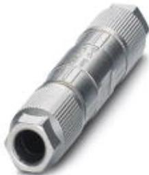
Кабельный соединитель, PROFINET CAT6A (10 Гбит/с), 8-полюсный, без галогенов, экранированный, разъем с ножевыми контактами, материал корпуса: цинковый сплав, никелированный, внешний диаметр кабеля 5 мм ... 9,7 мм
