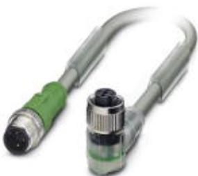
Кабель для датчика / исполнительного элемента, 3-полюсн., PUR без галогенов, стойкий к воздействию искр при сварке, повышенная гибкость, серый RAL 7001, Штекеры прямое M12, А-кодирование, к Гнездо угловой M12, А-кодирование, с 2 светодиодных, длина кабеля: 3 м, для использования на работах и тяговых цепях
