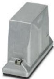
Сальниковый корпус B24, Винтовой зажим, материал: Из алюминия, методом литья под давлением, стойкий к морской воде, на заказ, высота: 93,7 мм, кабельный ввод: без, патрубок: Нет, Прибрежная зона/ЭМС, проводящее уплотнение (свойства ЭМС), без резьбового отверстия для завинчивания
