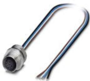
Встраиваемая розетка для датчика / исполнительного элемента, 4 контакта, M12, с механическим ключом А-типа, монтаж с передней части стенки / резьбовое крепление с Pg9, с гибким проводом 0,5 м (изоляция из TPE), 4 x 0,34 мм<sup>2</sup>
