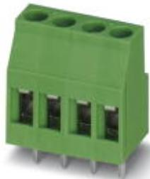
Клеммы для печатной платы, номинальный ток: 24 A, номинальное напряжение: 400 В, размер шага: 5,08 мм, полюсов: 2, тип подключения: Винтовой зажим с натяжной гильзой, монтаж: Пайка волной припоя, направление подключения, проводник/печатная плата: 0 °, цвет: зеленый. Возможна установка в ряд модулей с различным количеством полюсов (контактов)!
