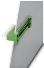
Компоненты для проходного монтажа, номинальный ток: 12 A, расчетное напряжение (III/2): 320 В, полюсов: 10, размер шага: 5 мм, тип подключения: Контакты под пайку / разъем для подключения плоского штекера, цвет: зеленый, поверхность контакта: олово, монтаж: Непосредственный монтаж, принадлежность арт.№ 5030172 применяется только вместе с MSTB 2,5/..ST и MSTBT 2,5/..ST.
