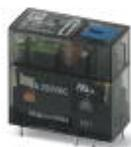
Вставное миниатюрное реле, с многослойным контактом и дополнительным твердым позолоченным покрытием, 2 переключающих контакта, кнопка для тестирования, механический индикатор коммутационного положения, статусный светодиод, диод свободного хода, полярность A1+, A2-, входное напряжение 24 В DC
