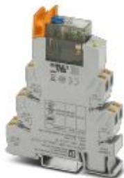
Релейная система PLC-INTERFACE, состоящая из базового модуля и вставного многопозиционного реле с золотыми контактами с ручным управлением, со встроенным светодиодом состояния и безынерционным диодом, Зажимы Push-in, 2 переключающих контакта, Входное напряжение: 24 В DC
