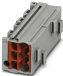
Сотовые клеммы, без нажимной кнопки, номинальное напряжение: 500 В, номинальный ток: 17,5 А, сечение: 0,14 мм<sup>2</sup> - 2,5 мм<sup>2</sup>, AWG: 14 - 26, тип подключения: Зажимы Push-in, полюсов: 1, количество подключений: 6, ширина: 11 мм, длина: 12,2 мм, цвет: серый, цвет элементов подключения: красный, монтаж: крепление защелками на адаптере для монтажной рейки, крепление защелками на фланце крышки
