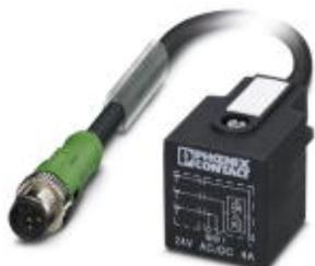
Кабель для датчика / исполнительного элемента, 3-полюсн., PUR без галогенов, темно-серый RAL 7021, Штекеры прямое M12, А-кодирование, к Штекер типа А для электромагнитного клапана, с 1 светодиод, подключение с помощью Диод Зенера, подключение с помощью Диод Зенера, длина кабеля: 2 м
