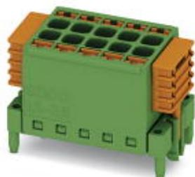
Разъем для установки прямо на печатную плату, номинальный ток: 8 А, расчетное напряжение (III/2): 160 В, полюсов: 3, размер шага: 3,5 мм, тип подключения: Пружинные зажимы Push-in, цвет: зеленый, поверхность контакта: олово, монтаж: SKEDD - Непосредственное подсоединение
