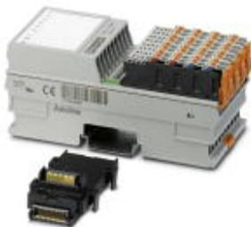
Axioline F, Модуль аналогового ввода, Аналоговые входы: 8, 0 В ... 5 В, -5 В ... 5 В, 0 В ... 10 В, -10 В ... 10 В, 0 мА ... 20 мА, 4 мА ... 20 мА, -20 мА ... 20 мА, способ подключения: 2-проводная схема, скорость передачи данных в локальной шине: 100 Мбит/с, для необслуживаемых приложений SAFE AI с непрерывной эксплуатацией, степень защиты: IP20, с цокольным модулем шины и штекерами Axioline F
