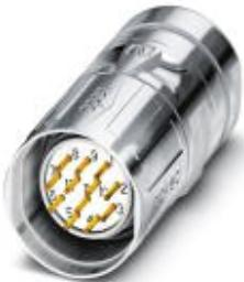
Кабельный соединитель, прямой, экранирован.: есть, Крепление SPEEDCON, M23, Полосов: 16+3, тип контактов: Штифт, Подключение пайкой, диапазон диаметра кабеля: 3 мм ... 14,5 мм
